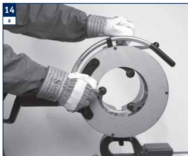
Grib fast i håndtag og drej med/mod urets retning til stregerne mødes.
