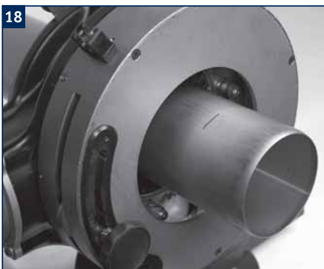
18 Placér røret efter ønsket længde.
