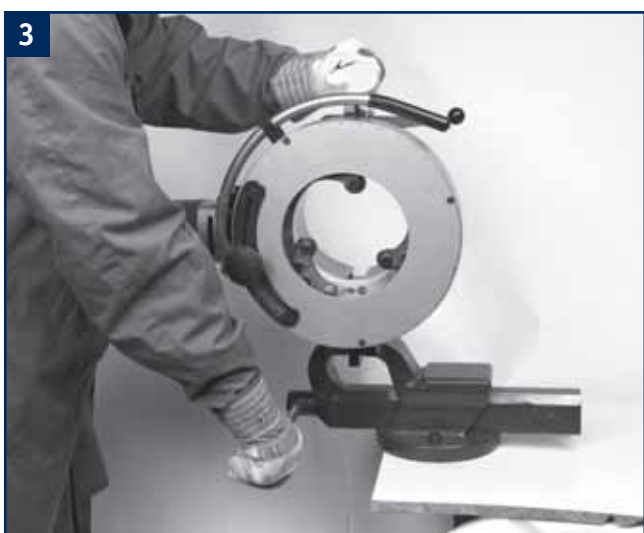
3 Le coupe-tube est équipé d'une semelle qui permet de le maintenir fixé dans un étau.
