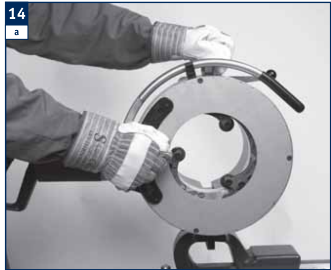
14 a Linker seitlicher Knauf ziehen, sodass die Drehsperrung aufgehoben ist und Schneidmodul drehen bis die Markierung des Schneidmoduls sich gegenüber der Markierung des Rohrschneiders befindet.
