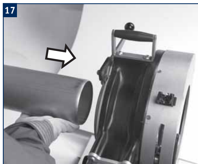
Isæt rør fra bagsiden.
