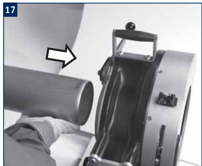
17 Das Rohr von links einlegen.
