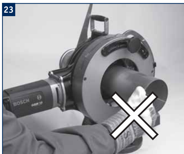
Hold ikke i rør eller skjæredel under kutting.
