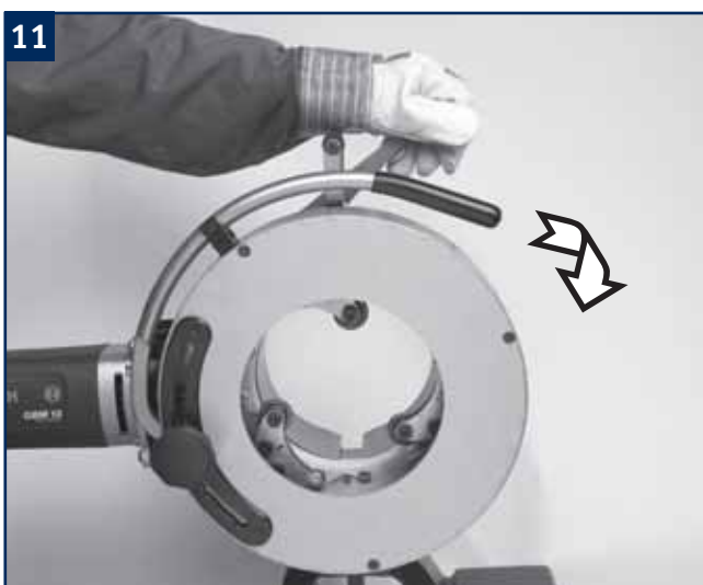
11 Den linken Hebel zum Spannen der Schneidmodule nach vorne schieben um den Einsatzbacken zu öffnen.
