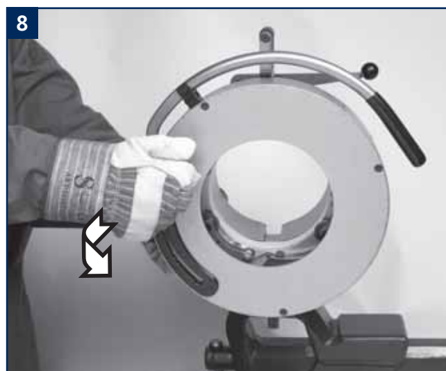
Trekk håndtaket ut for valg av rørstørrelse.
