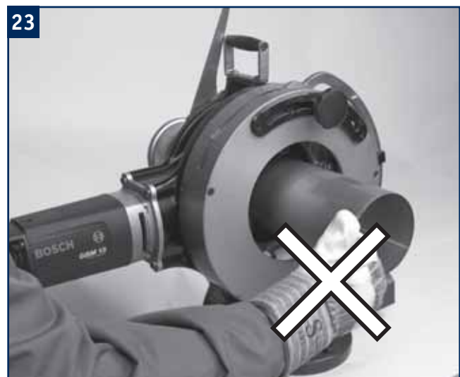
23 Während des Schneidvorgangs und während das Schneidmodul rotiert, darf das Rohrende und das Schneidmodul nicht berührt werden.
