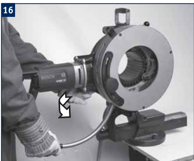
Skv skæremodulens åpningsarm tilbake.
