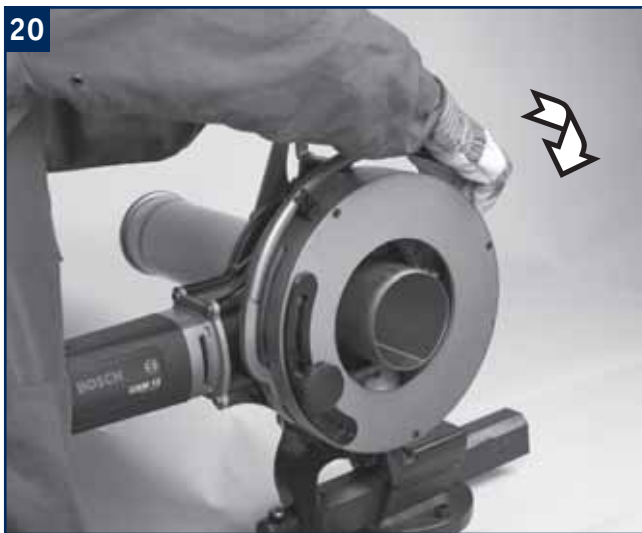
20 Den Hebel des Spannmoduls ziehen, wieder in die Halterung einschieben.
