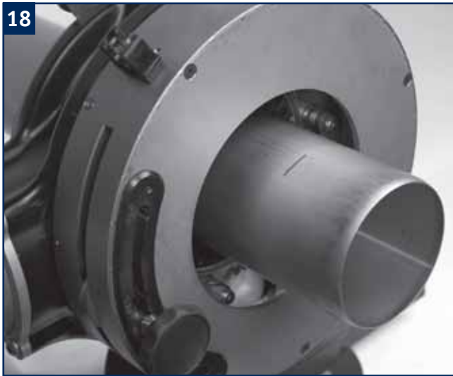
18 Das Rohr an der vorher markierten Länge plazieren.
