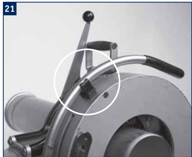
21 Es ist sicherzustellen, dass der Hebel des Spannmoduls in der Halterung eingerastet ist.
