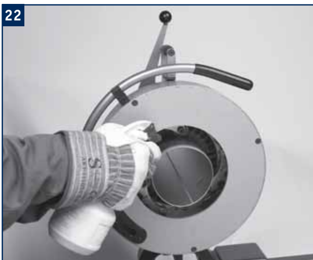
22 Am Schneidrad Schneidflüssigkeit zuführen.
