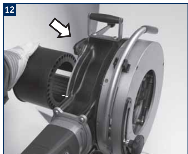
12 Den Einsatzbacken der gewünschten Rohrdimension einsetzen.
