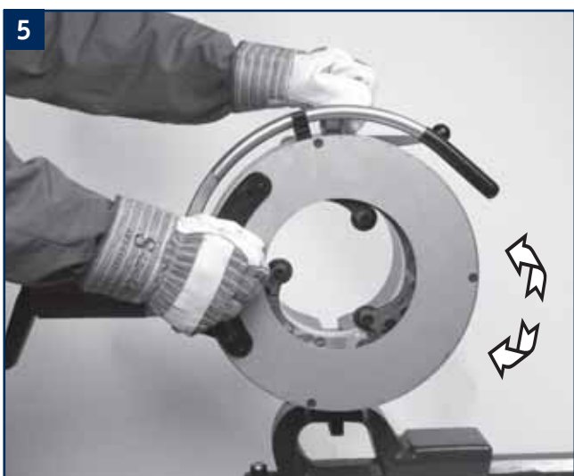
5 Saisir la poignée et tourner dans le sens de la montre/ dans le sens opposé, jusqu'à ce que les traits se rencontrent.
