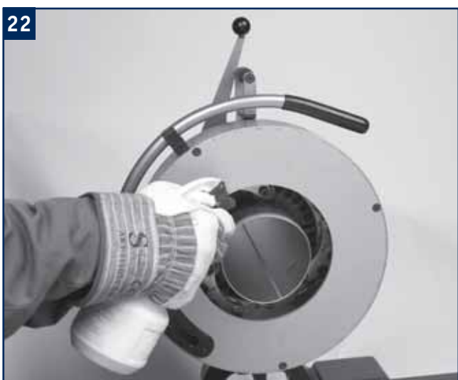
Sprøyt skjæremiddel på kuttstedet.
