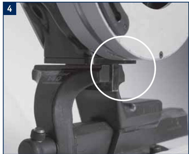
4 NB. Sørg for at skæredelen er monteret uden for skruestikket, så rørskeereren kan køre frit rundt.
