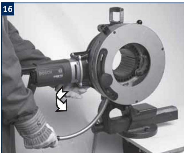
16 Den Hebel zum Öffnen des Schneidmoduls nach hinten ziehen.
