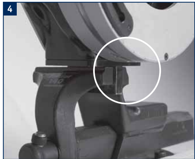
4 NB. Påse at skjæredelen står utenfor skrustikka slik at denne kan rotere fritt.
