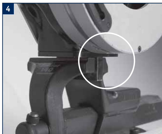
4 N.B. S'assurer que la partie coupante soit placée en dehors de l'étau de manière à ce que le coupe-tube puisse tourner librement.
