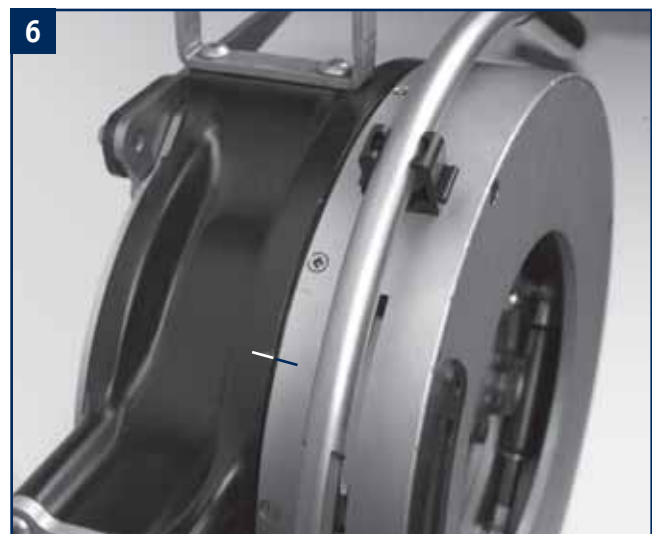
Sicherstellen, dass sich das Schneidmodul ausserhalb des Schraubstocks befindet, damit der Rohrschneider ungehindert rotieren kann.
