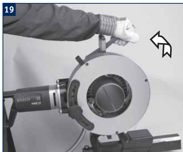
19 Træk håndtaget tilbage for at låse tilspændingsmodulet.
