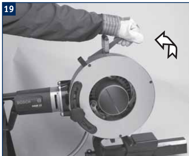
Trekk håndtaket tilbake for å låse spennmodulen.
