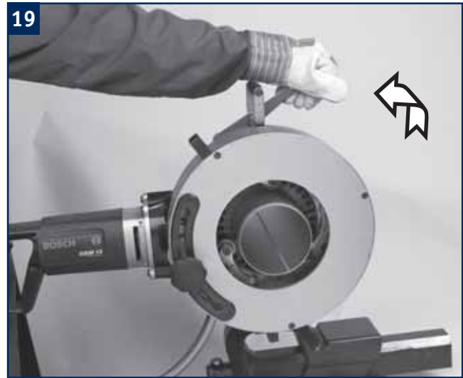
19 Tirer la poignée dans l'autre sens pour verrouiller le module de serrage.
