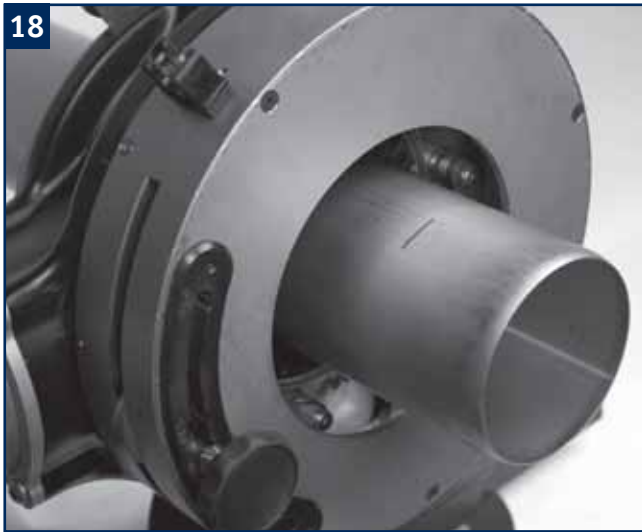
18 Placer le tube selon la longueur désirée.
