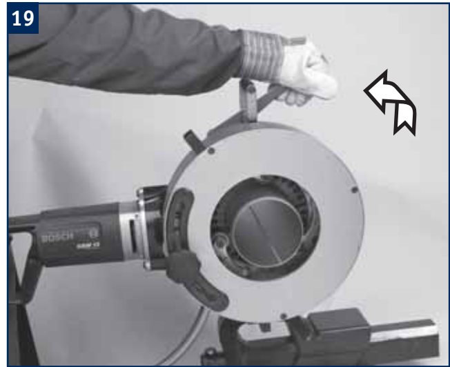
19 Den Spannhebel zurückziehen, um das Spannmodul zu fixieren.
