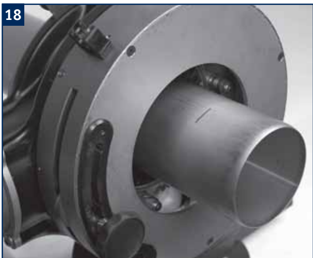
Plasser røret etter ønsket lengde.
