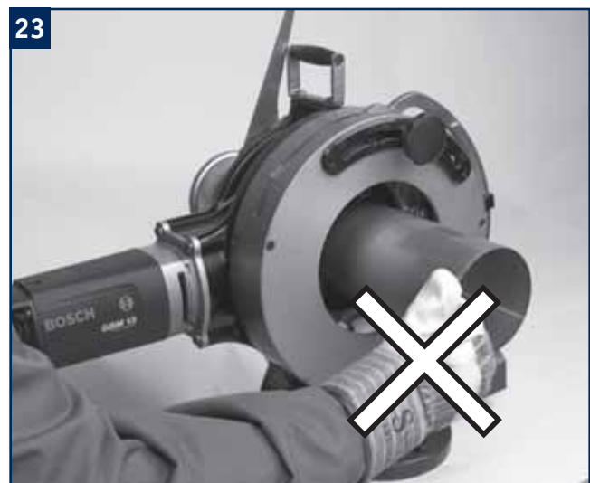
23 Ne pas poser ses mains sur le tube ni sur les parties qui coupent le tube et qui tournent lorsque la machine est en marche.
