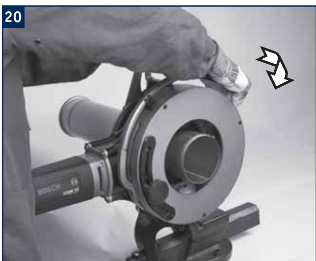
Skv håndtaket for å stramme trinsene på plass.
