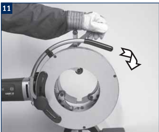
Skv spennmodulens håndtak frem for å åpne innsatsbakken.
