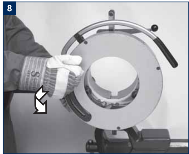
8 Rechter Knauf ausziehen, um die gewünschte Rohrdimension zu wählen.
