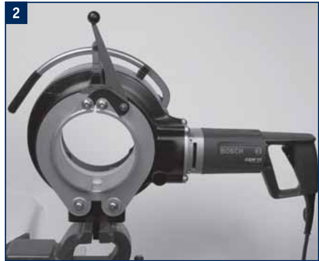
2 Rörkapverktyget ska spännas fast ordentligt vid användning.
