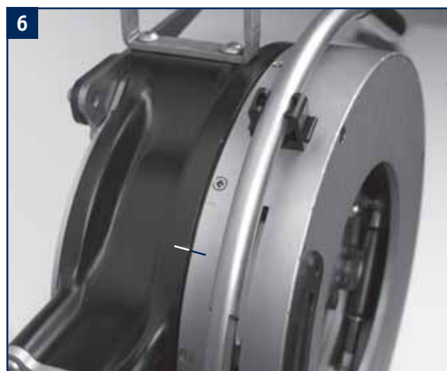
4 N.B. S'assurer que la partie coupante soit placée en dehors de l'étau de manière à ce que le coupe-tube puisse tourner librement.
